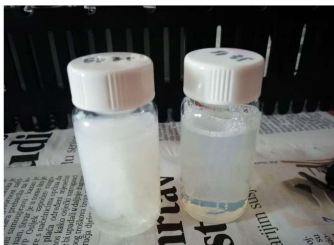
Slika 20. Uzorak u prvoj bočici uslikan je neposredno nakon ulijevanja vode u koktel. Nakon što dobro protresemo smjesu dobijemo homogenu, bistriju otopinu u kojoj se radon iz vode vezao za molekule koktela.
