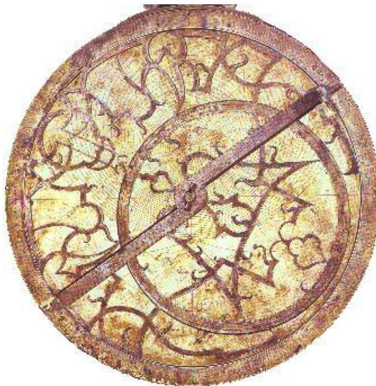
Slika 8: Astrolab, astronomski instrument koji se do 18. stoljeća koristio za navigaciju [11]
