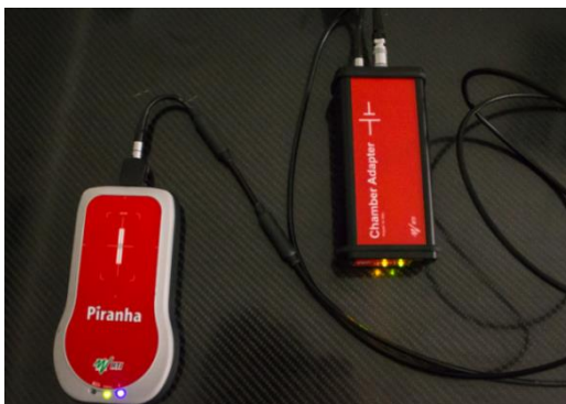
Slika 33. Mjerenje CTDI_{vol} (provjeravanje).
