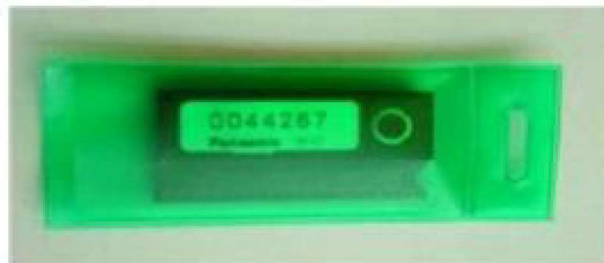
Slika 17. Panasonic UD-802AT dozimetar korišten pri mjerenju.
