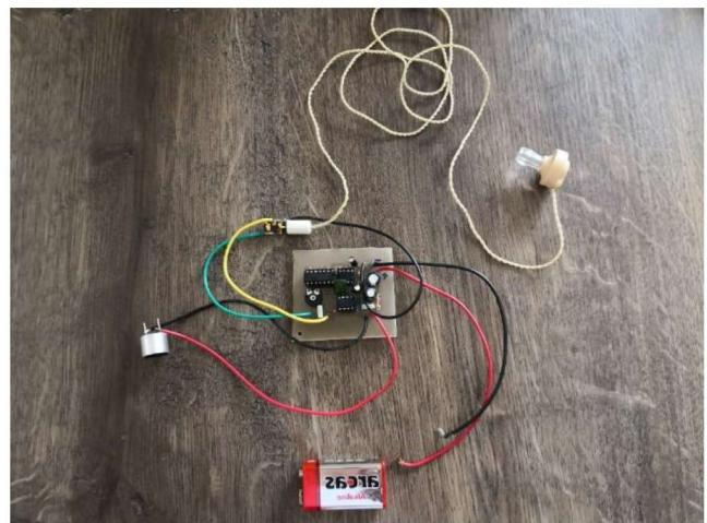
Slika 26. b) Spojene komponente Bat detektora
