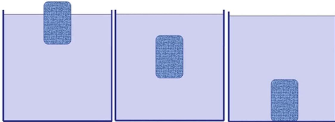
**Slika 9.** Na lijevoj slici sila teža na tijelo je manja od uzgona i tijelo će plivati. Na srednjoj slici sila sila teža na tijelo je izjednačena sa uzgonom zbog čega tijelo lebdi. Na desnoj slici sila teža na tijelo je veća od uzgona i tijelo tone [11]
