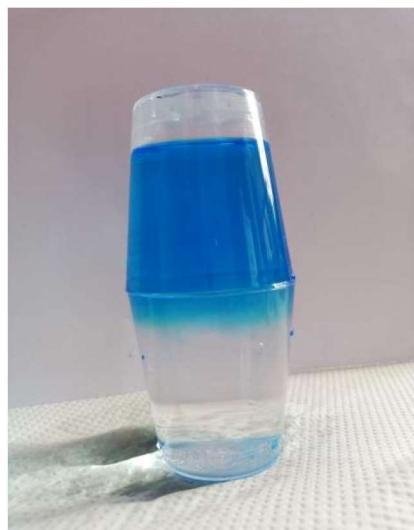
**Slika 17.** Separacija slojeva као последица различитих температура, а time i gustoća vode
