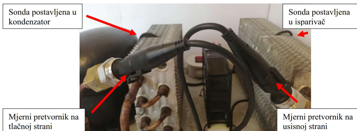
Slika 28. Postavljanje mjernih pretvornika i sondi
