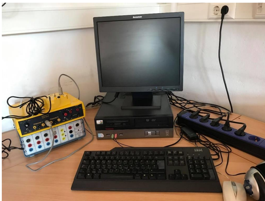
Slika 2.1. Aparatura za mjerenje temperature; Sastoji se od uređaja marke NTL computer physics na kojemu su spojeni termometri i od računala na koje je spojen taj uređaj
