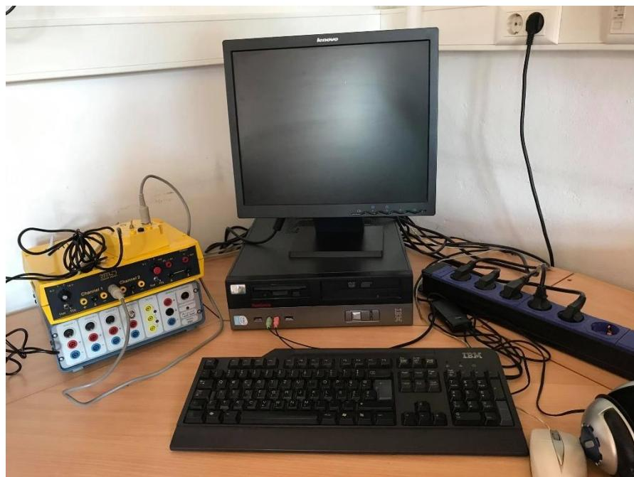
**Slika 2.1. Aparatura za mjerjenje temperature; Sastoji se od uređaja marke NTL computer physics na kojemu su spojeni termometri i od računala na koje je spojen taj uređaj**
