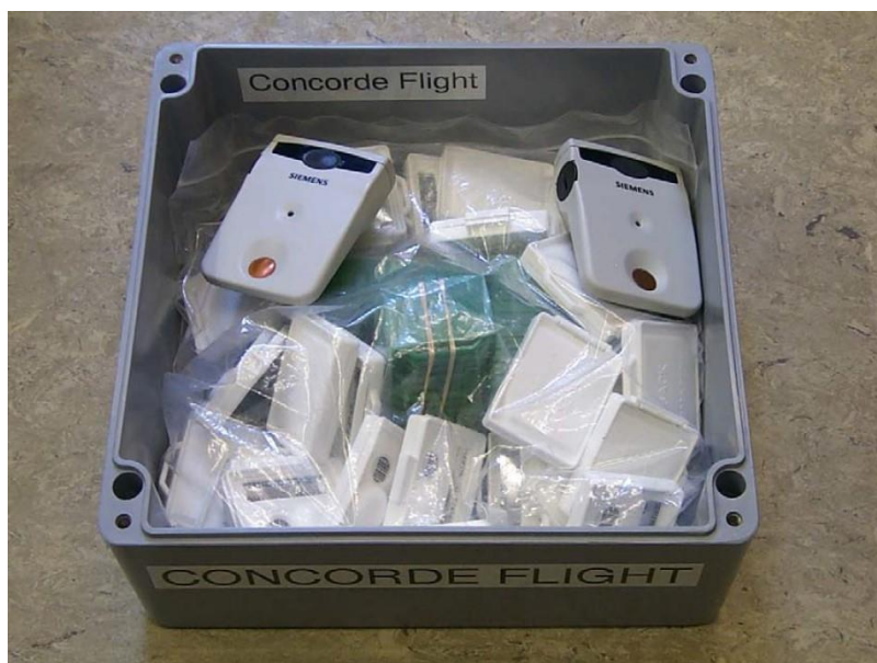
Slika 2. Kutija NRPB sa pasivnim i dva elektronička dozimetra koji su bili upotrebljavani prilikom leta zrakoplova Concorde [22]
