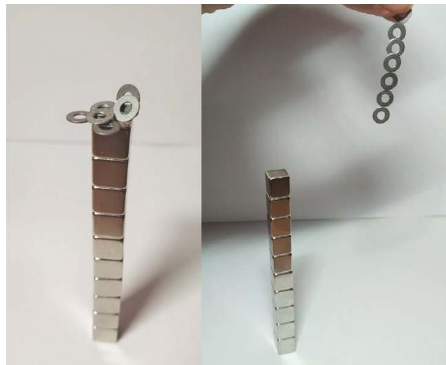
Slika 20: Prikaz prisutnosti magnetizacije feromagneta i nakon odmaka od magneta
