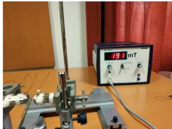
Slika 24: Mjerenje magnetskog polja između neodimijskih magneta
