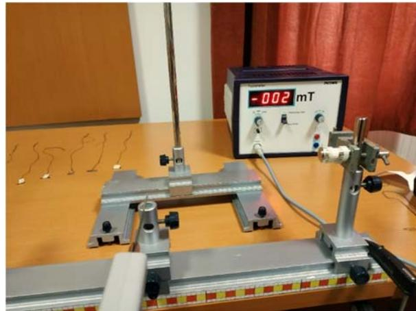
Slika 23: Mjerenje magnetskog polja prije primijene polja
