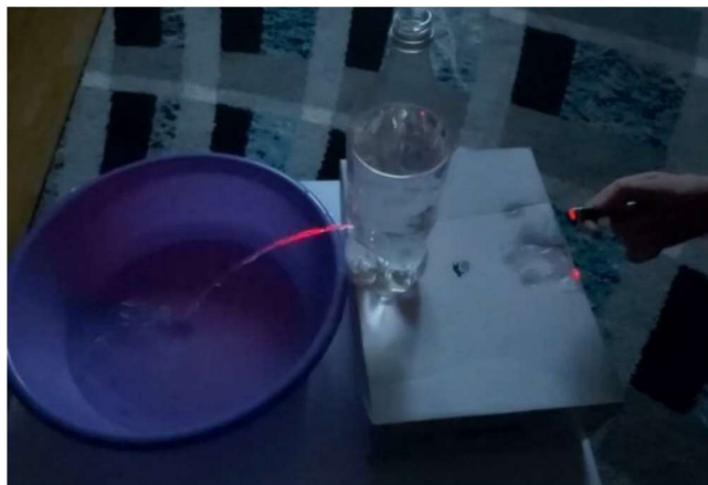
Slika 14. Prikaz svjetlosti lasera koja prati zakrivljenost mlaza vode
