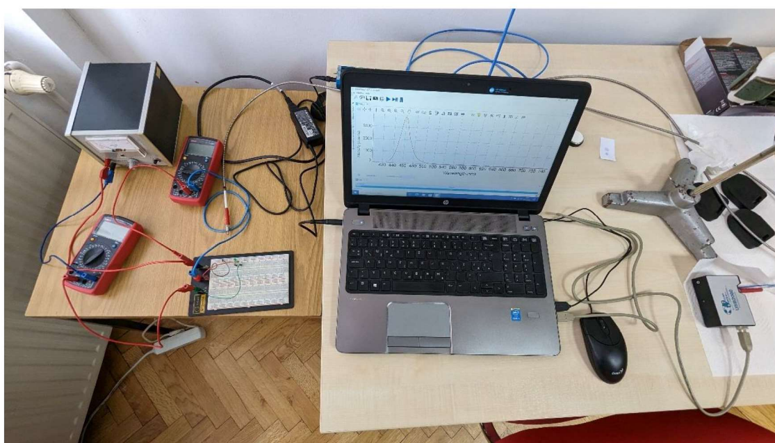
Slika 21. Eksperimentalni postava za određivanje valne duljine pomoću spektrometra
