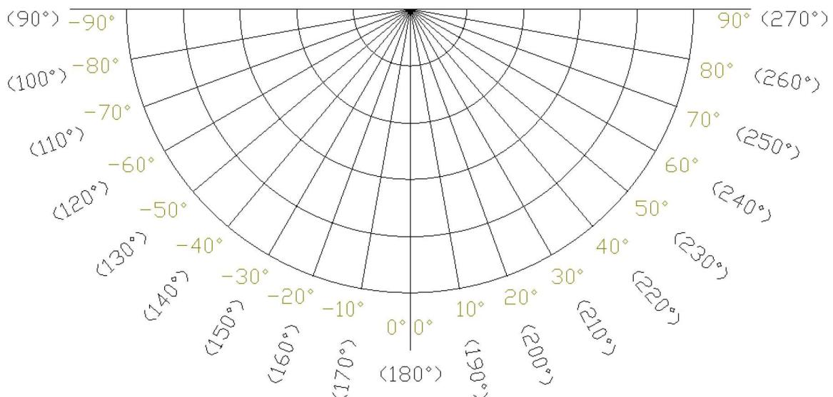
Slika 42. Skala kutomjera i ekvivalentni kutovi u slučaju kada je cijev brojača iza izvora.
