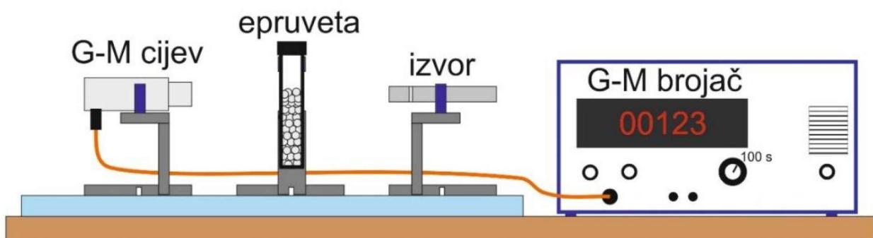
Slika 29. Eksperimentalni postav modela radioaktivnog razinomjera.
