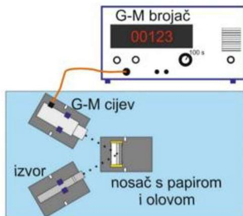
Slika 34. Eksperimentalni postav modela refleksijskog radioaktivnog debljinomjera (tlocrt).
