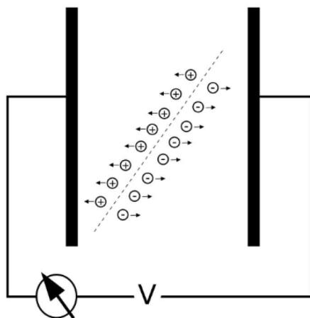
Slika 20. Shema ionizacijske komore: elektrode stvaraju električno polje - anoda (desno) i katoda (lijevo), spojenih na izvor napona i ampermetar koji služi za mjerjenje ionizacijske struje. [44]
