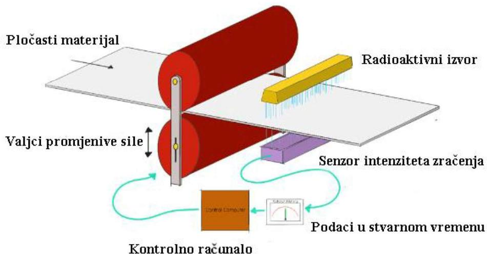
Slika. 24. Mjerenje debljine materijala pomoću radioaktivnog izvora. Pločasti materijal postavljen je između valjaka, a zračenje prolazi kroz materijal i detektira se, nakon čega su vidljivi podaci o debljini materijala, koju je moguće korigirati promjenom sile na valjcima. [49]
