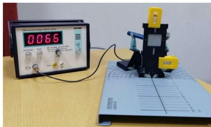
Slika 33. Eksperimentalni postav modela radioaktivnog refleksijskog debljinomjera.
