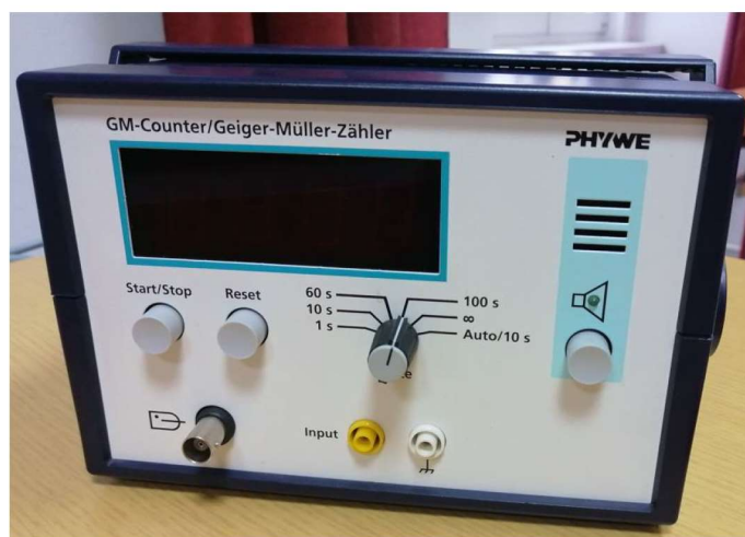
Slika 22. Geiger-Müllerov brojač proizvođača PHYWE.
