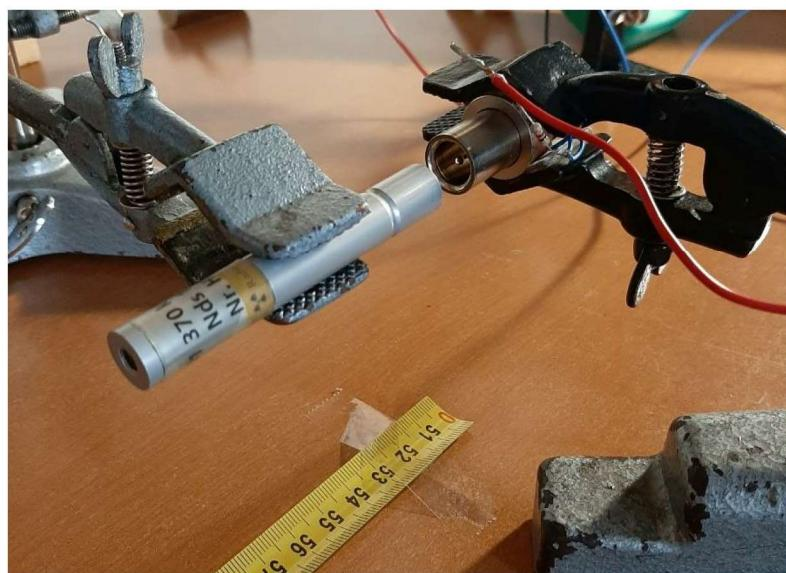
Slika 16. Eksperiment s malom ionizacijskom cijevi.
