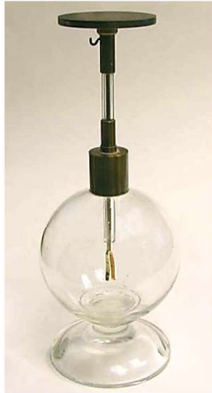
Slika 6. Elektroskop sa zlatnim listićima [14]
