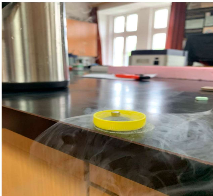
Slika 14. Magnetska levitacija pomoću tekućeg dušika.
