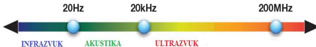
Slika 19. Podjela zvučnih valova prema frekvencijama [50]
