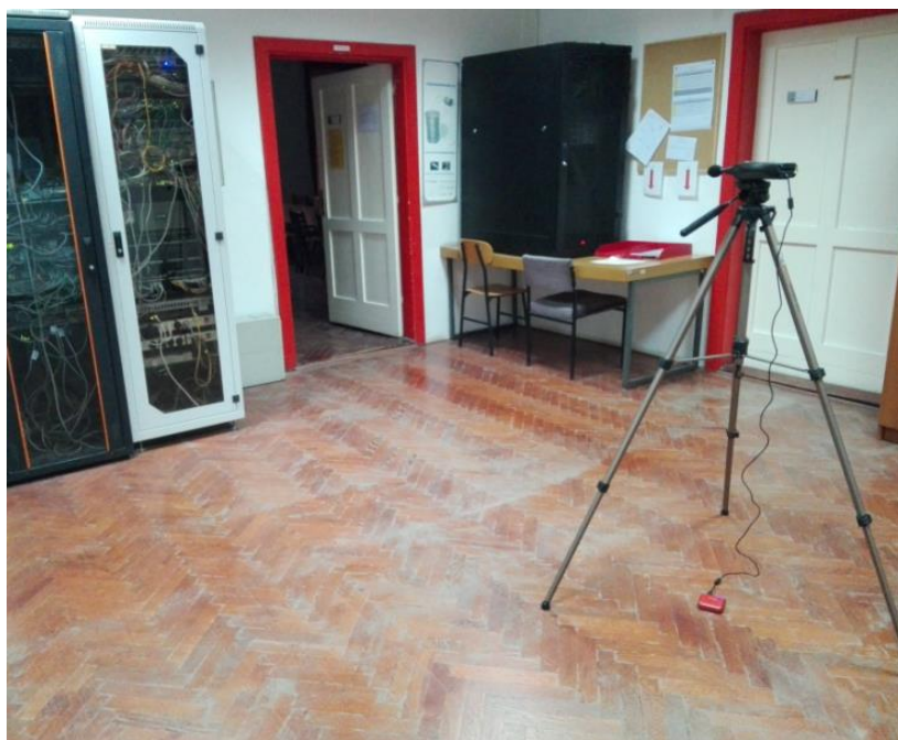
Slika 30. Postavljanje zvukomjera i mjerenje razine intenziteta zvuka
