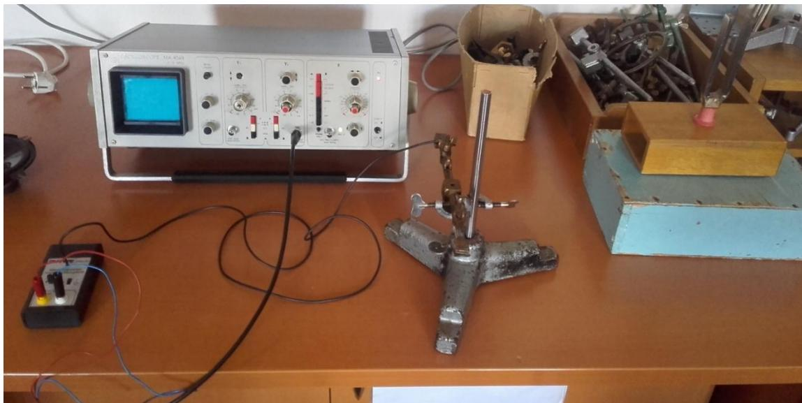
Slika 28. Aparatura za mjerjenje frekvencije glazbene vilice
