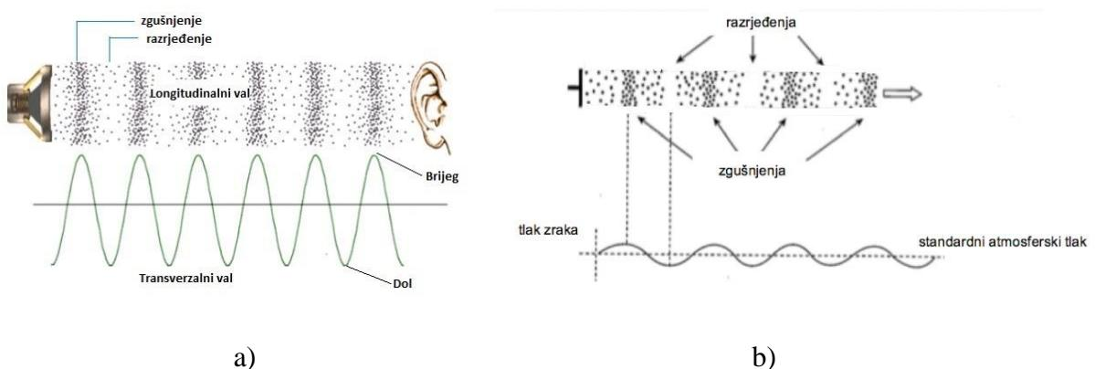
Slika 2. Usporedba zvučnog (longitudinalnog) i transverzalnog vala [14, 24]
