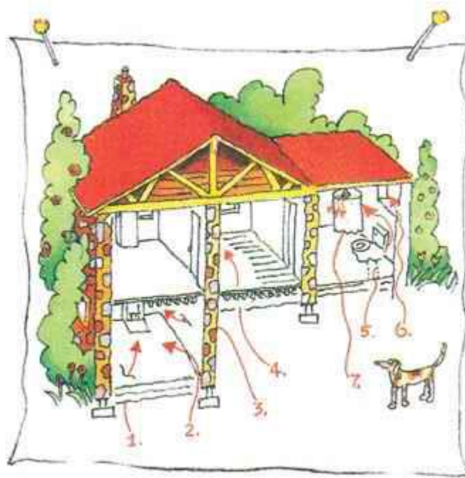
Slika 7: Načini ulaska radona u kuću [24]
