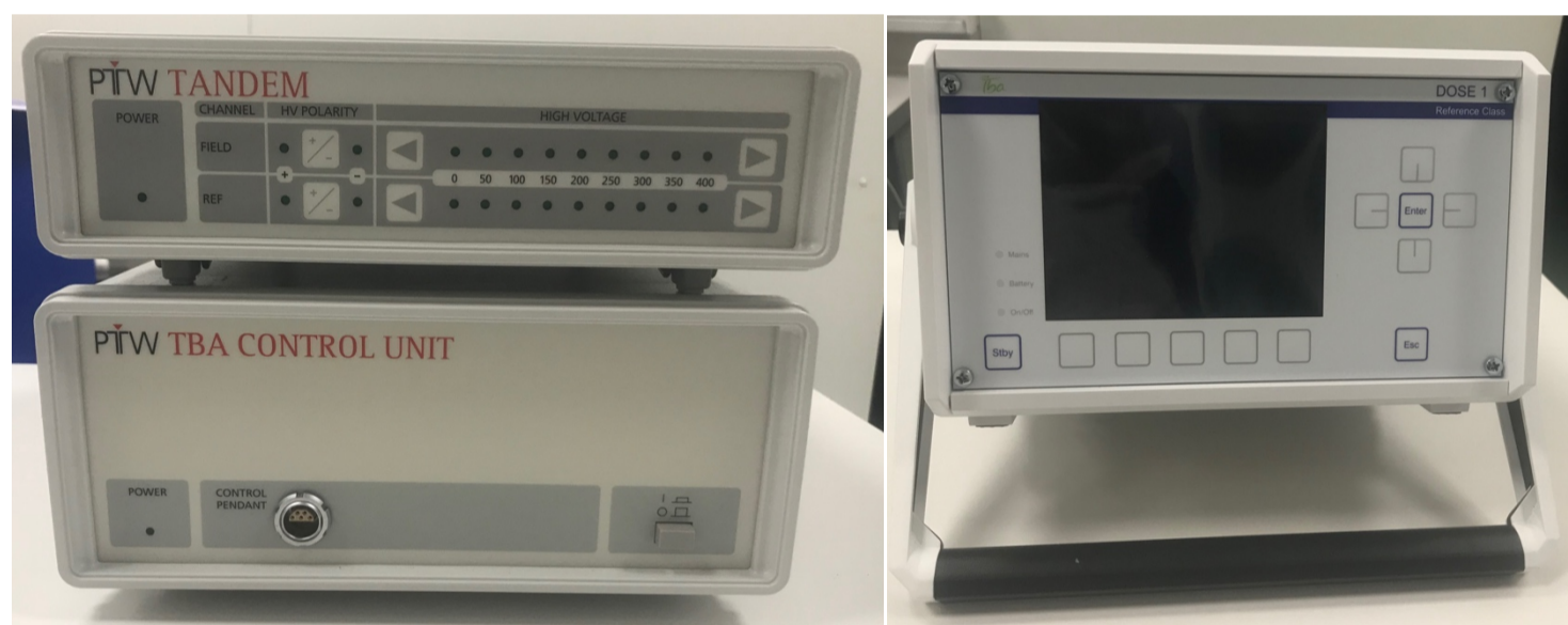
Slika 31. : Elektrometar TANDEM (PTW) s lijeva, te elektrometar UNIDOS E (PWT) s desna
