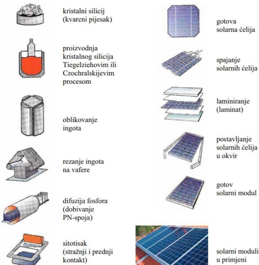
Slika 14. Postupak proizvodnje ćelija i solarnih panela [2]
