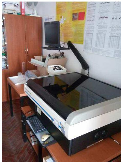
**Slika 10.** TriCarb 2900 tekućinski scintilacijski detektor.
