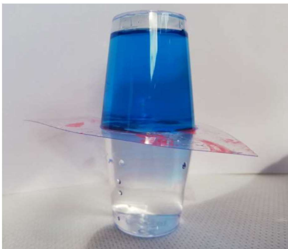
Slika 16. Način postavljanja gornje čašice (napunjene toplom vodom) na donju (napunjenu hladnom vodom)
