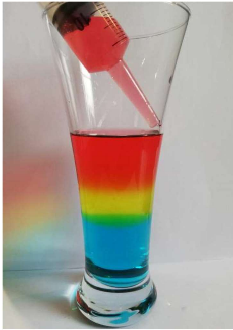
Slika 14. Položaj šprice prilikom ispuštanja novog sloja tekućine
