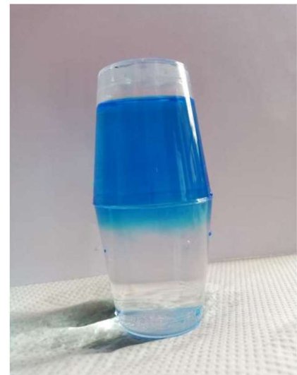
Slika 17. Separacija slojeva kao posljedica različitih temperatura, a time i gustoća vode
