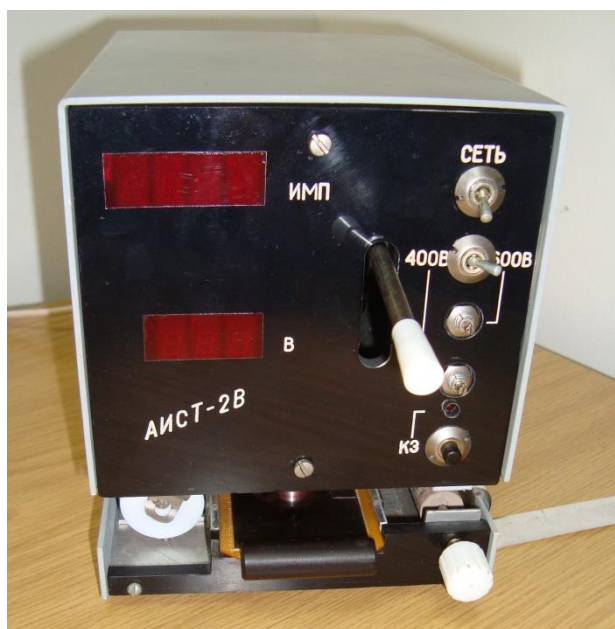
Slika 14. Uređaj Spark Counter AIST-2V
