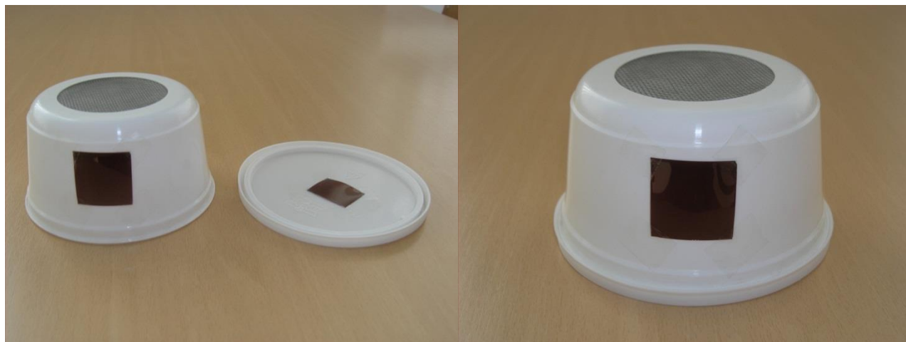
Slika 9. Detektor – plastična posudica s filmovima
