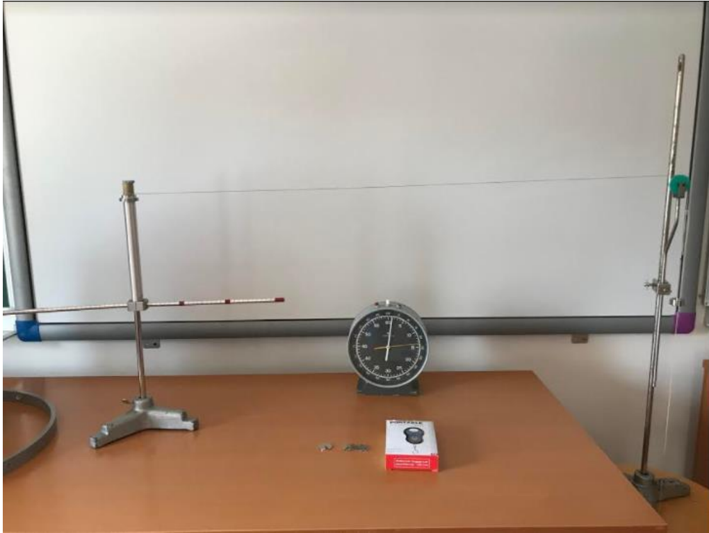
Slika 8. Aparatura za određivanje momenta tromosti metalne šipke
