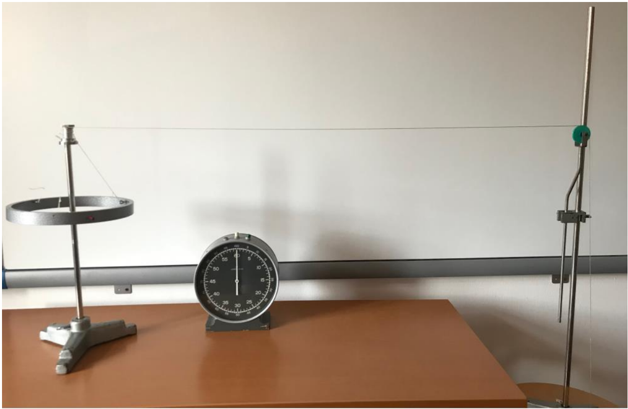
Slika 7. Aparatura za određivanje momenta tromosti obruča
