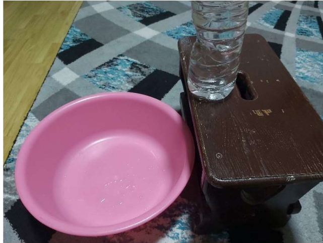
Slika 13. Pravilno postavljanje boce, postolja i posude za vodu
