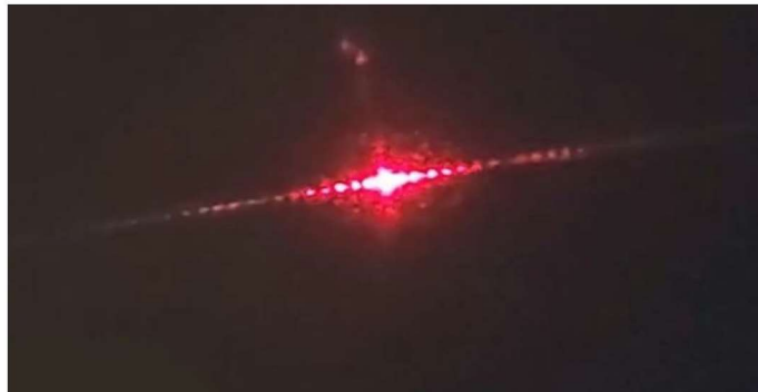
Slika 22. Interferencijski uzorak svjetlosti na paru linija sa nešto većem međusobnom razmaku
