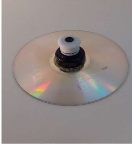
Slika 7. Čep zalijepljen na otvor CD-a
