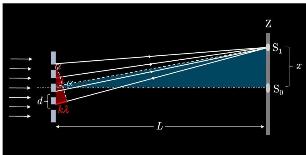
Slika 16. Ogib svjetlosti na optičkoj rešetki [20]
