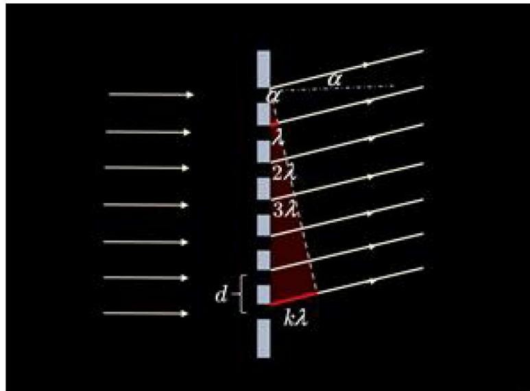
Slika 15. Ogib svjetlosti na optičkoj rešetki [20]
