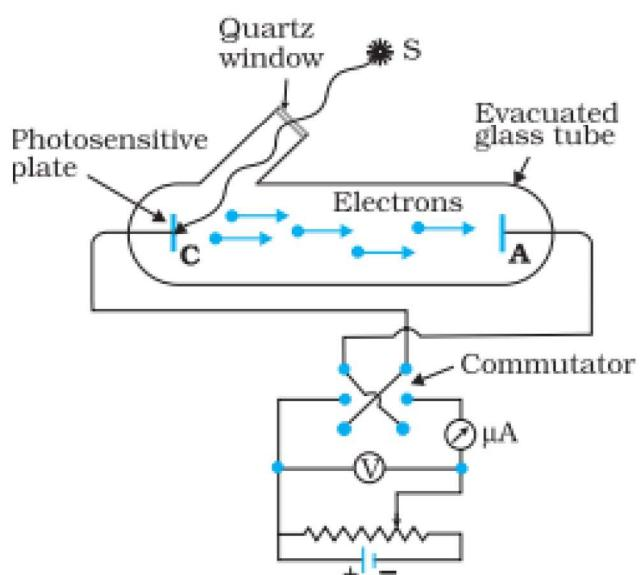
Slika 3. Lenardov eksperimentalni postav za ispitivanje fotoelektričnog efekta [4]
