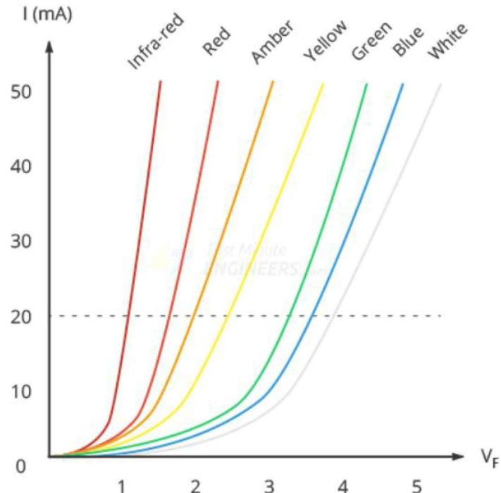
Slika 9. Strujno-naponska karakteristika LED dioda različitih boja [14]
