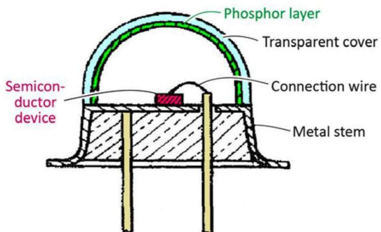
Slika 11. Poprečni presjek LED diode s fosfornim premazom [15]
