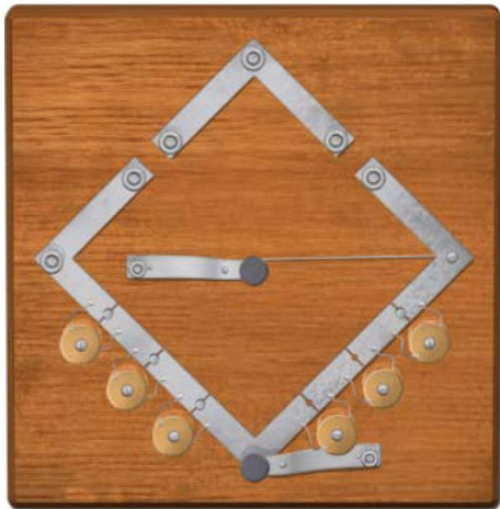
Slika 6. Koncept Christievog mosta za mjerenje otpora [15]
