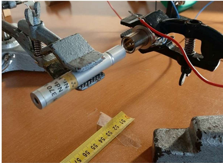
Slika 16. Eksperiment s malom ionizacijskom cijevi.
