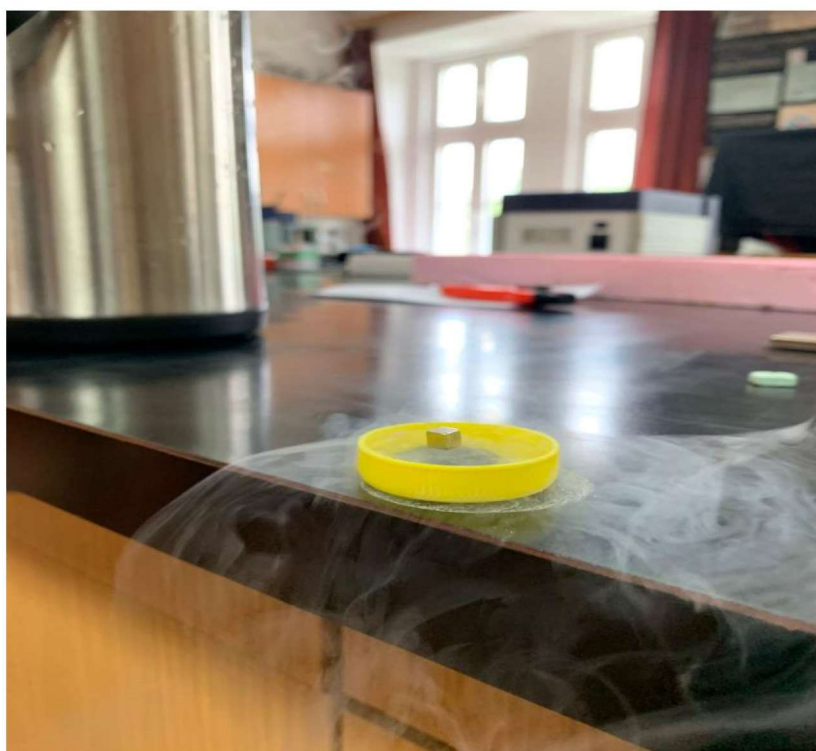
Slika 14. Magnetska levitacija pomoću tekućeg dušika.
