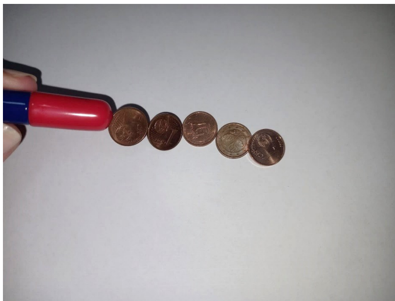
Slika 14. Prikaz magnetskog dosega uz pomoć kovanica (1 cent).
