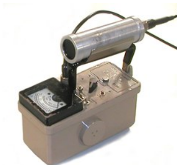
Slika 27. Geiger – Müllerova cijev s otvorom na jednom kraju [42]
