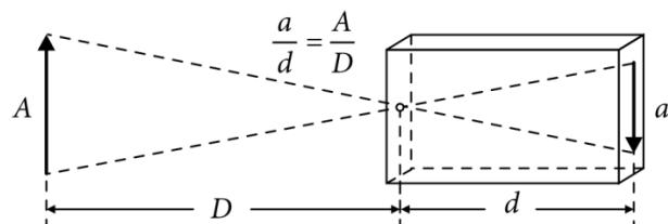
**Slika 19.** Princip rada tamne komore: zrake svjetlosti se odbijaju od predmeta (A), prolaze kroz mali otvor na kutiji i padaju na njezin nasuprotni zaslon (a). Veličina projekcije ovisi o udaljenosti predmeta od kamere (D) i otvora (objektiva) od zaslona (d).
