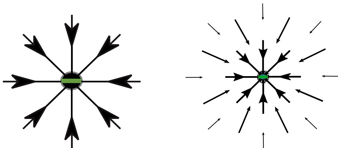
Slika 2. 3. Silnice električnog polja pozitivnog i negativnog naboja
