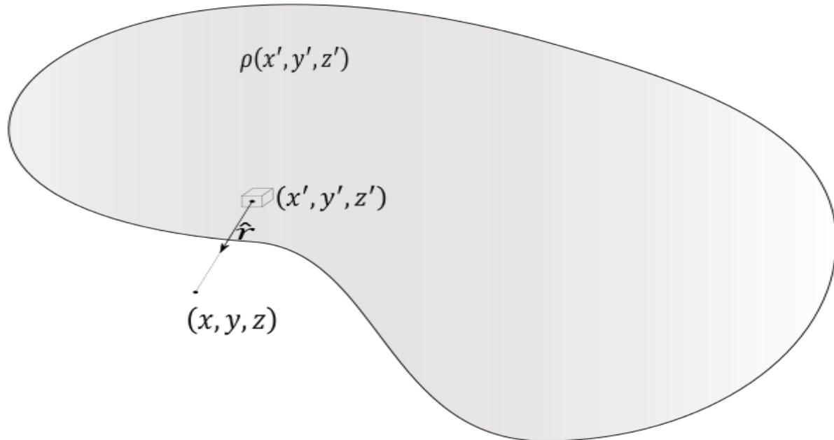
Slika 2.5. Gustoća električnog naboja unutar proizvoljnog volumena
