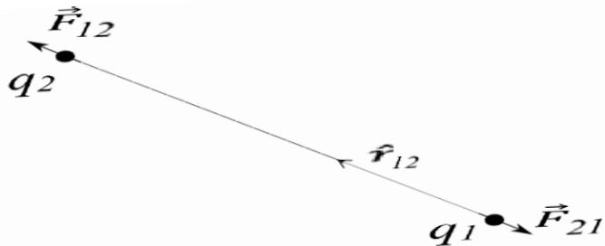
Slika 2. 1. Dva električna naboјa na udaljenosti  $r$
