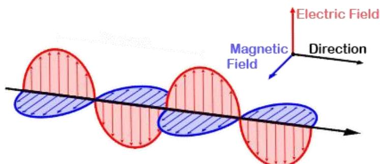
Slika 3.1 Elektromagnetski val<sup>2</sup>
