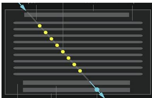
Slika 4. Komora na iskre [10]
