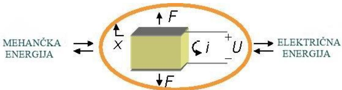
Slika 6: Piezoelektrični efekt [8]
