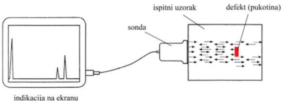
Slika 21 : Metoda ultrazvučnog ispitivanja materijala [16]
