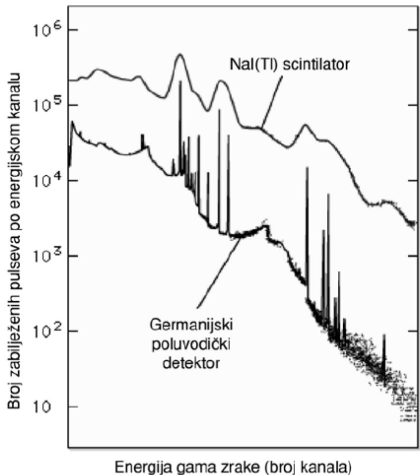
Slika 17: Rezultat mjerjenja scintilacijskim i germanijskim detektorom [41]
