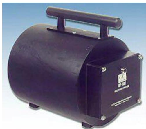
**Slika 18:** Prijenosni detektor za neutrone [41]
