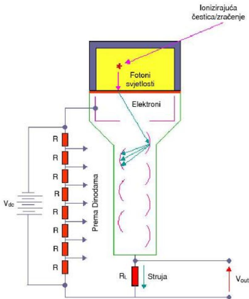
**Slika 16:** Shematski prikaz scintilacijskog detektora s fotomultiplikatorom [42]
