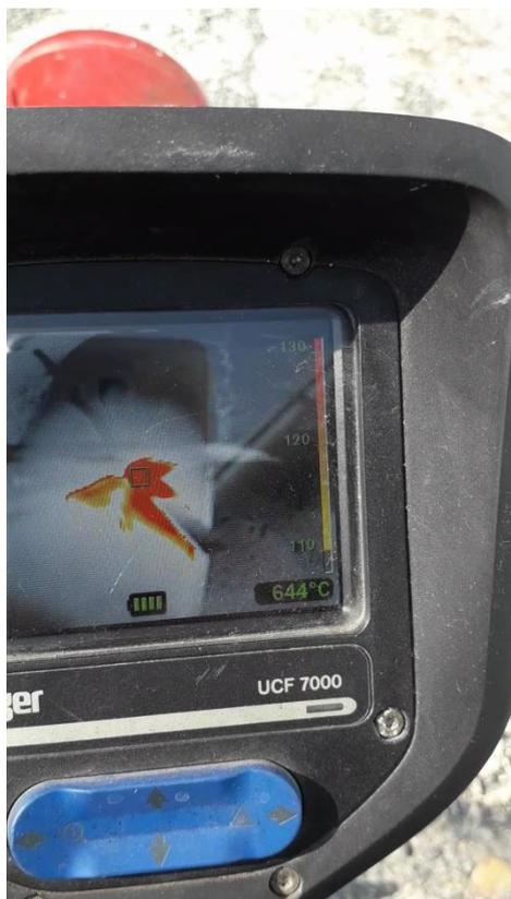
**Slika 43. Prikaz temperature paljenja drvene letve**
