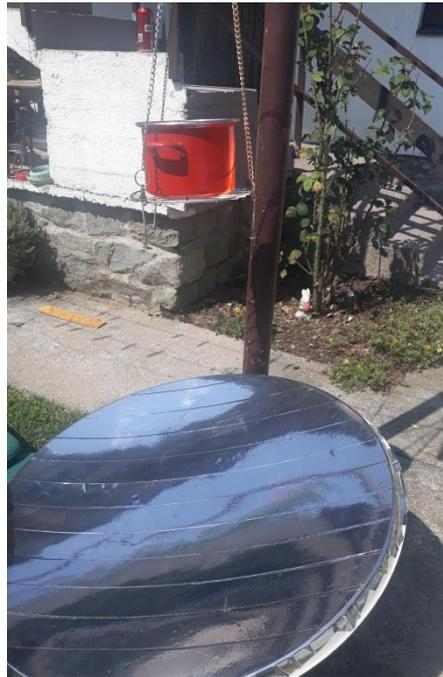
**Slika 44. Parabolično zrcalo kao solarno kuhalo**
