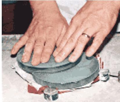
**Slika 17. Izrada paraboličnog zrcala [2]**
