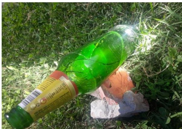
**Slika 45. Prikaz napuknute staklene boce zbog visoke temperature**
