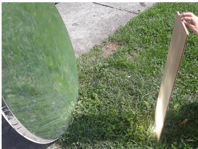
**Slika 38. Određivanje vrijednosti žarišta paraboličnog zrcala**
