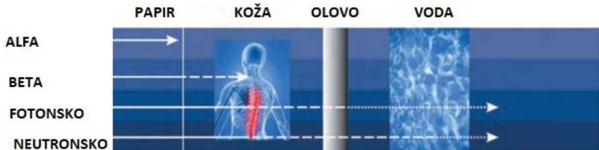
Slika 3. Sposobnost prodiranja različitih vrsta ionizirajućeg zračenja [2]
