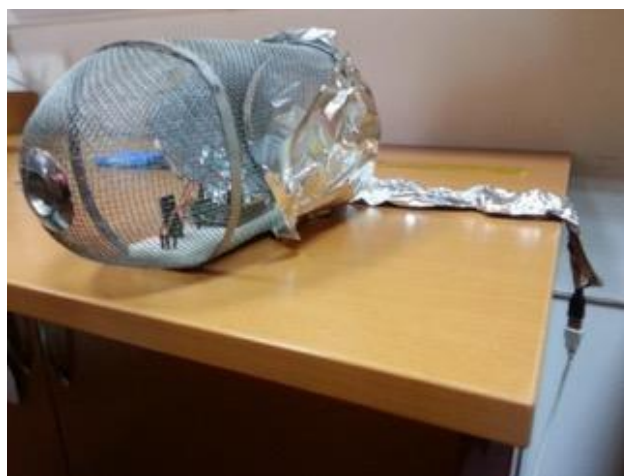
Slika 27. Arduino u Faradayevom kavezu
