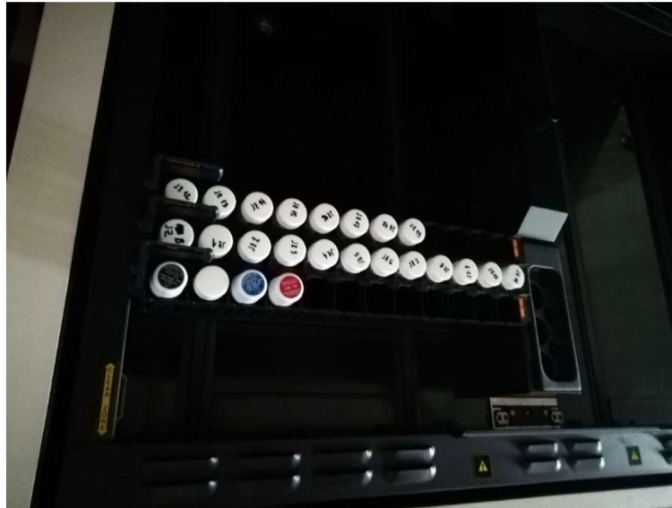
Slika 22. Kazeta za kalibraciju i kazete sa pripremljenim uzorcima za mjerenje unutar uređaja TriCarb 2900.
