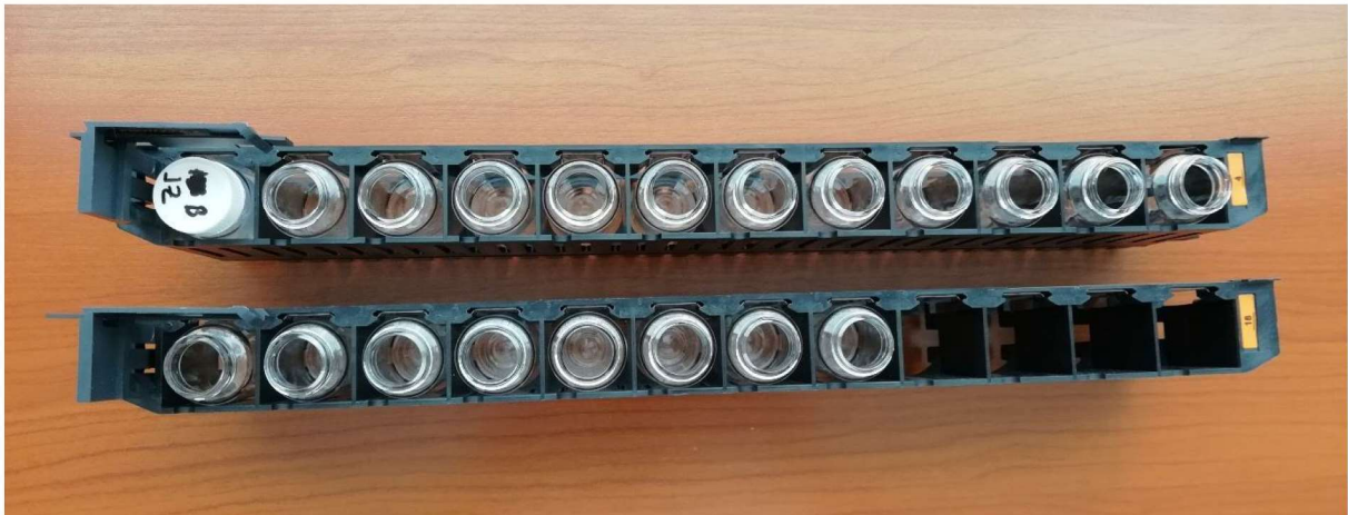
Slika 16. Prikaz kazeta u kojima se nalaze još uvijek prazne vialice za uzorke vode te vialica sa destiliranom vodom za mjerenje pozadinskog zračenja.
