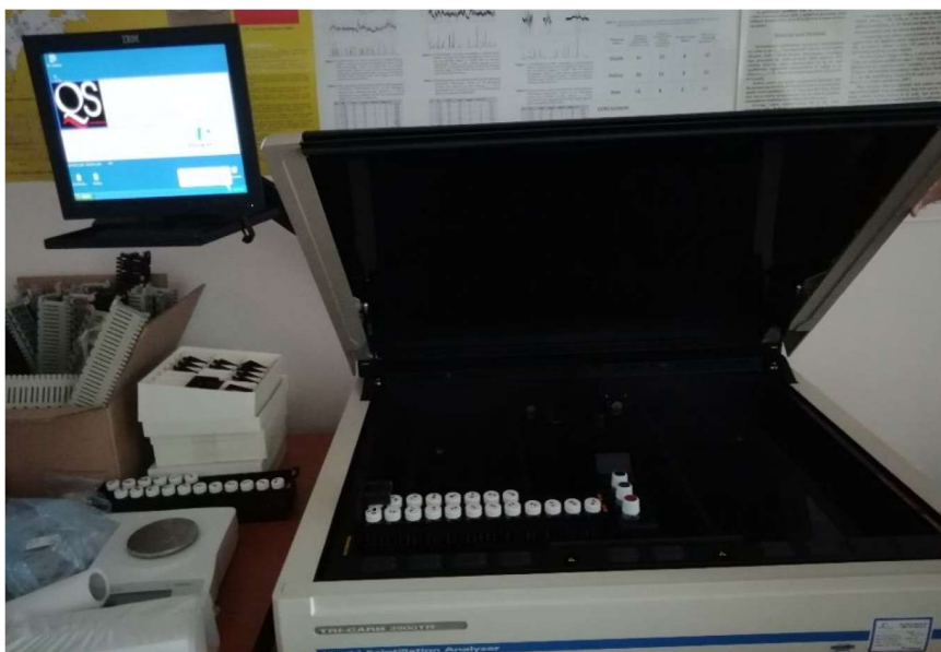
Slika 23. TriCarb uređaj- uređivanje postavki mjerenja.
