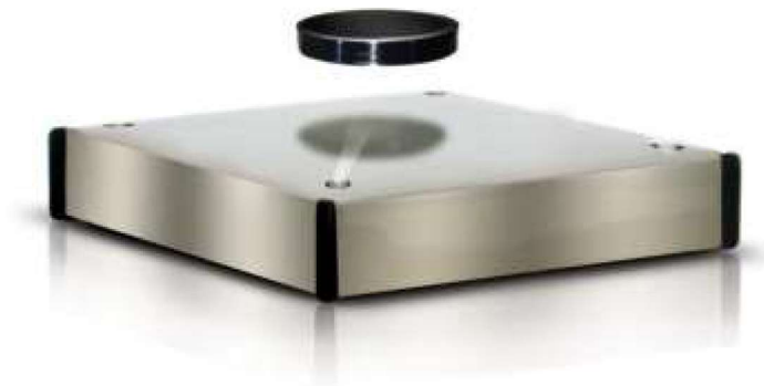
Slika 5: Levitacija magneta iznad supravodiča [12]
