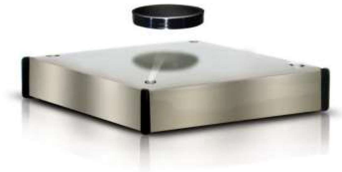
Slika 5: Levitacija magneta iznad supravodiča [12]
