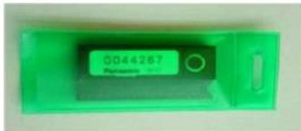
Slika 17. Panasonic UD-802AT dozimetar korišten pri mjerenju.
