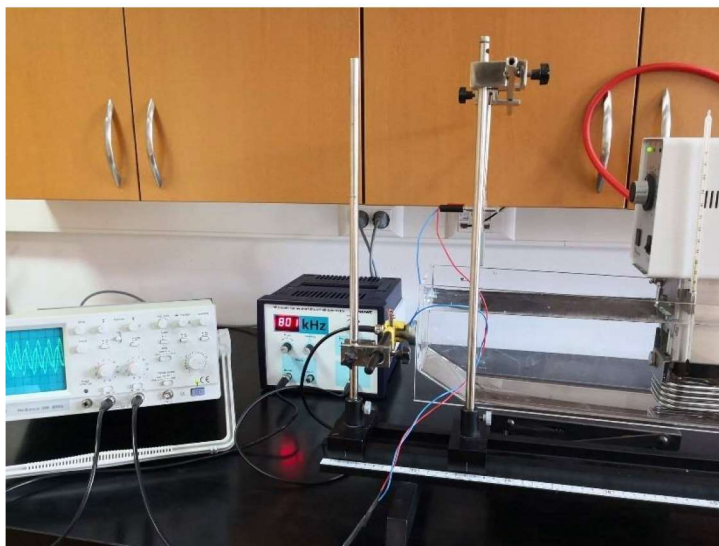
Slika 20. Aparatura složena za pokus (dodan je termostad i grijač).
