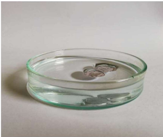
Slika 2. Novčić na površini zdjelice prilikom laganog spuštanja u vodu pomoću spajalice
