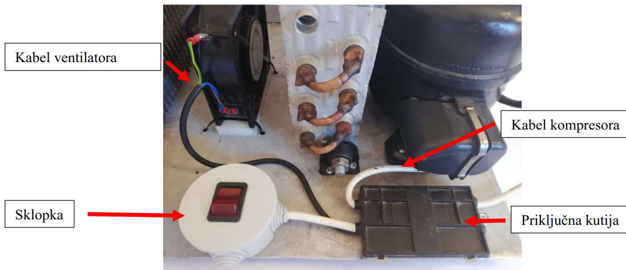
Slika 27. Spajanje električnih komponenti
