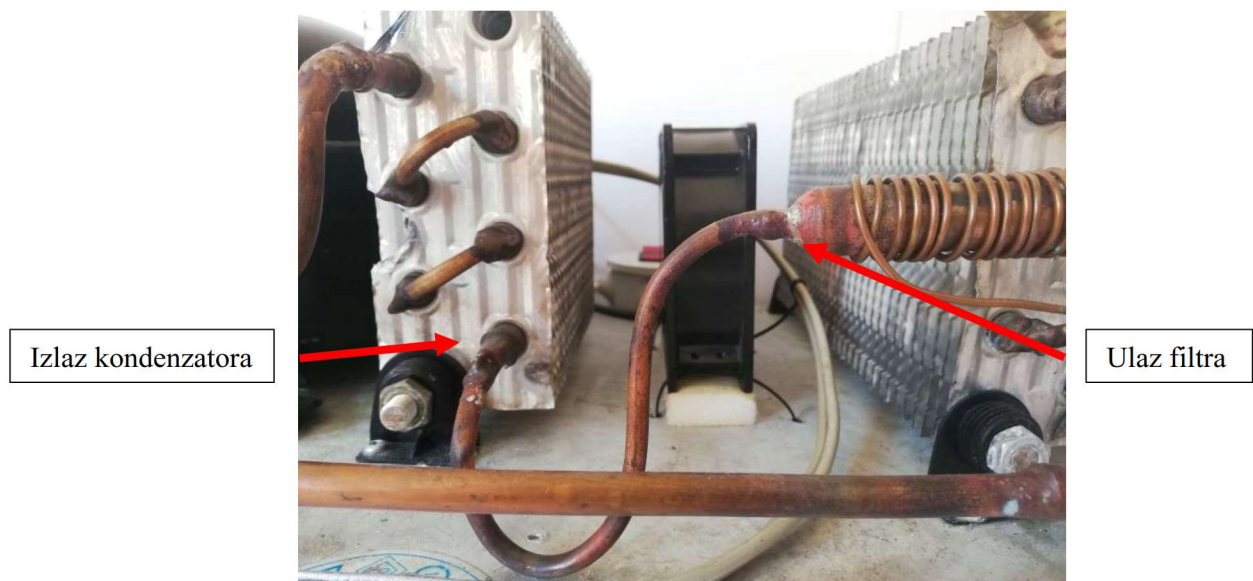
Slika 24. Povezivanje izlaza kondenzatora s ulazom filtra (sušača)
