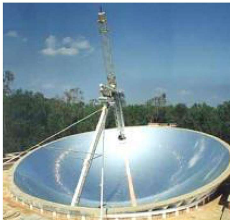
Slika 12 Primjer srednjemetemperaturnog kolektora [15]
